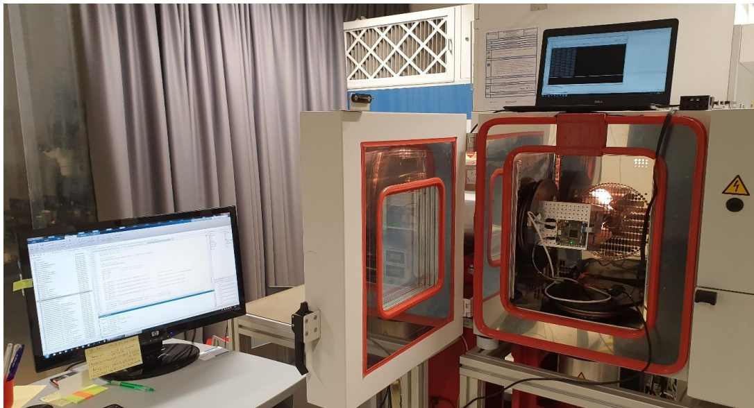
Abb. 3.1: Inertial-Messplatz bestehend aus Drehtisch AC1120S von Acutronic, Temperatur-Kammer von Vötsch und Steuer-Rechner
