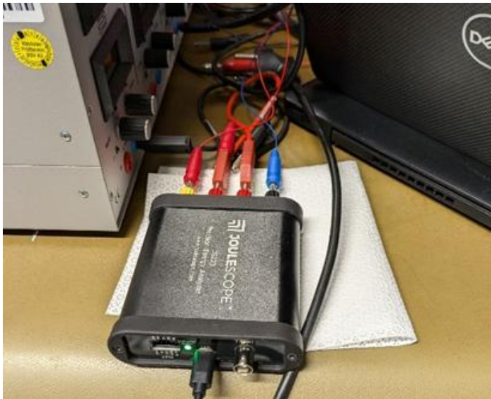
Abb. 3.3: Joulescope JS220 zur Aufnahme der Versorgungsspannung und Stromaufnahme.
