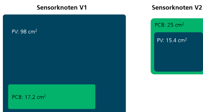
Abbildung 8: Größenvergleich von alter und neuer Sensorplattform
